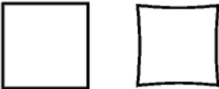
Figure 20-41 Image normale (à gauche) et image avec distorsion en « coussinet » (à droite)
