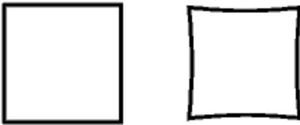
Figure 20-42 Image normale (à gauche) et image avec distorsion en « coussinet » (à droite)
